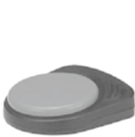
VOCA (音声出力コミュニケーション装置) スイッチや画面に触れると、録音した声や登録されている音声が出て話ができる。あいさつや要求、司会進行、買い物等にも使える。50音入力できるものもある。
