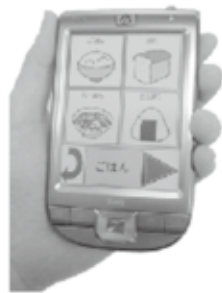
VOCA (音声出力コミュニケーション装置) スイッチや画面に触れると、録音した声や登録されている音声が出て話ができる。あいさつや要求、司会進行、買い物等にも使える。50音入力できるものもある。
